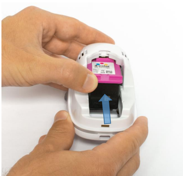
Fig. 32 : Insérer la cartouche d'encre
