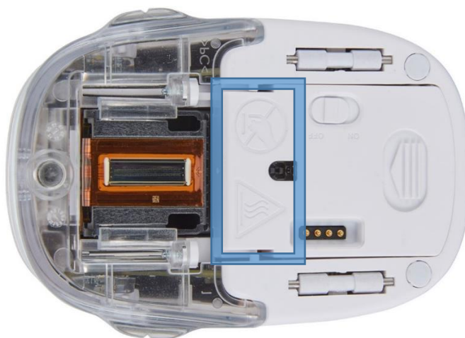
Fig. 1 : Consignes de sécurité sur la face inférieure de l'e-mark
