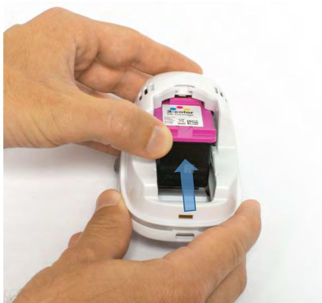
Abb. 13: Tintenpatrone einlegen
