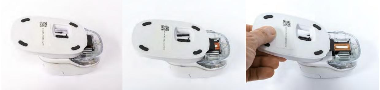
Abb. 29: Druckkopf mit dem Wischer reinigen
