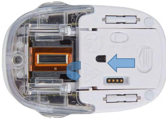
Abb. 43: Schiebefach öffnen
