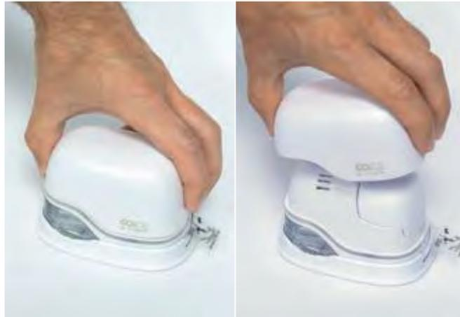
Abb. 40: Deckel öffnen und abnehmen
