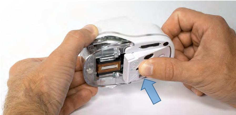
Fig. 14: Unteren Klappdeckel schließen
