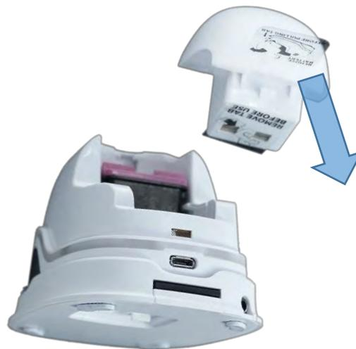
Abb. 10: Isolierfolie Batteriekontakte
